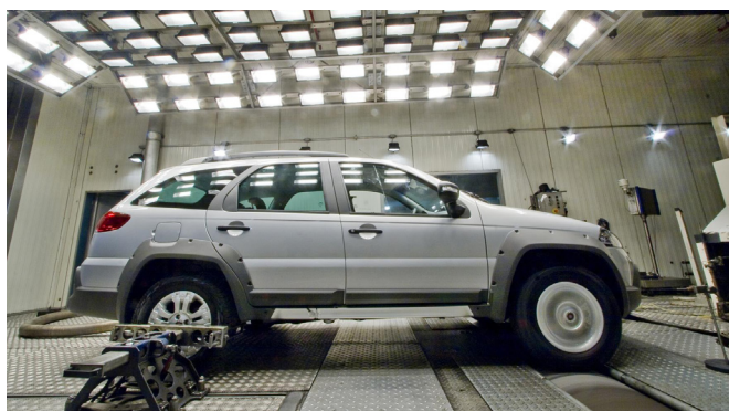
Figura 2 – Câmara climática com dinamômetro de rolo
